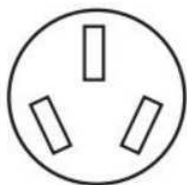
Tomacorriente de 3 hilos (10-50R)
